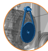
Transmissão com redução para aumentar o torque
