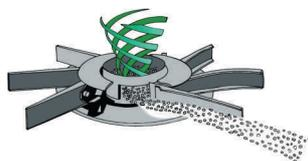
O fertilizante/semente passa através de uma câmara especial onde já inicia o movimento de rotação e leva sempre à parte central dos discos. Já em rotação, o produto desliza suavemente pela pá, que aplica uma aceleração gradual para um
