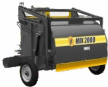
O Misturador **JF Mix 2000** é destinado a alimentação pecuária de pequeno porte. Sua função é desensilar, misturar, transportar e descarregar no cocho vários tipos de materiais ensilados a fim de preparar uma ração adequada para a alimentação do gado.
