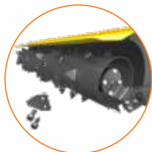
Desensilador con sistema de cuchillo cruzada y desarmable
