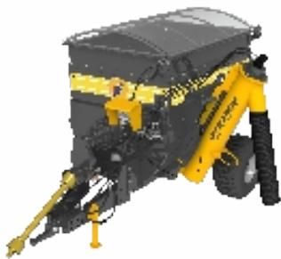
**JF Mix 4000/6000 CS** são misturadores de sal e concentrado com tanque de mistura, rosca misturadora e chupim em INOX, esse equipamento é extremamente resistente em especial nas áreas de contato com produtos abrasivos e corrosivos. Equipado
