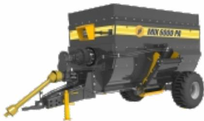
O Vagão Misturador **JF Mix 4000/6000 PA** possui sistema de mistura que representa um novo conceito. Formado por rotor e pás misturadoras posicionadas para obter uma mistura mais uniforme e aerada, preserva as
