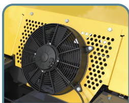
Ventilador para limpieza de anudadores
